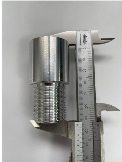
Wenn die Gewindeverlängerung auf das Antennengewinde aufgeschraubt ist, ergibt sich eine Gesamtlänge der Verschraubung von 6,5 cm.
